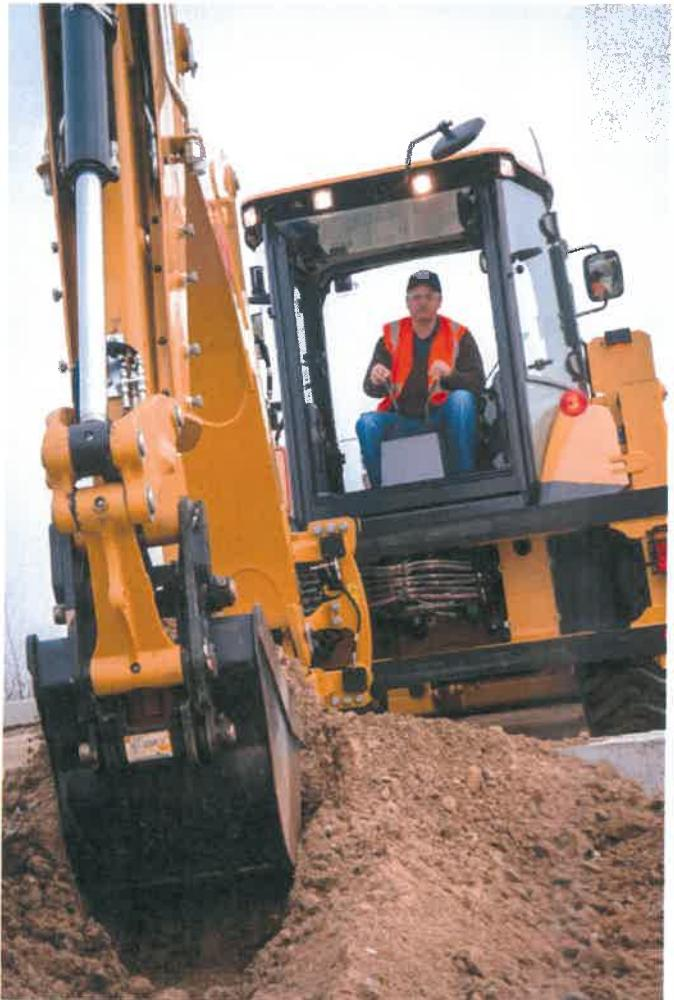
Modelul 428F2 este echipat cu comenzi mecanice, oferind o operare fără efort, cu posibilitatea de a alege între modelele de control ISO (Excavator) sau SAE (Sistem excavare). Operare simplă și sigură pentru operatori, indiferent de experiența sau abilitățile acestora.
